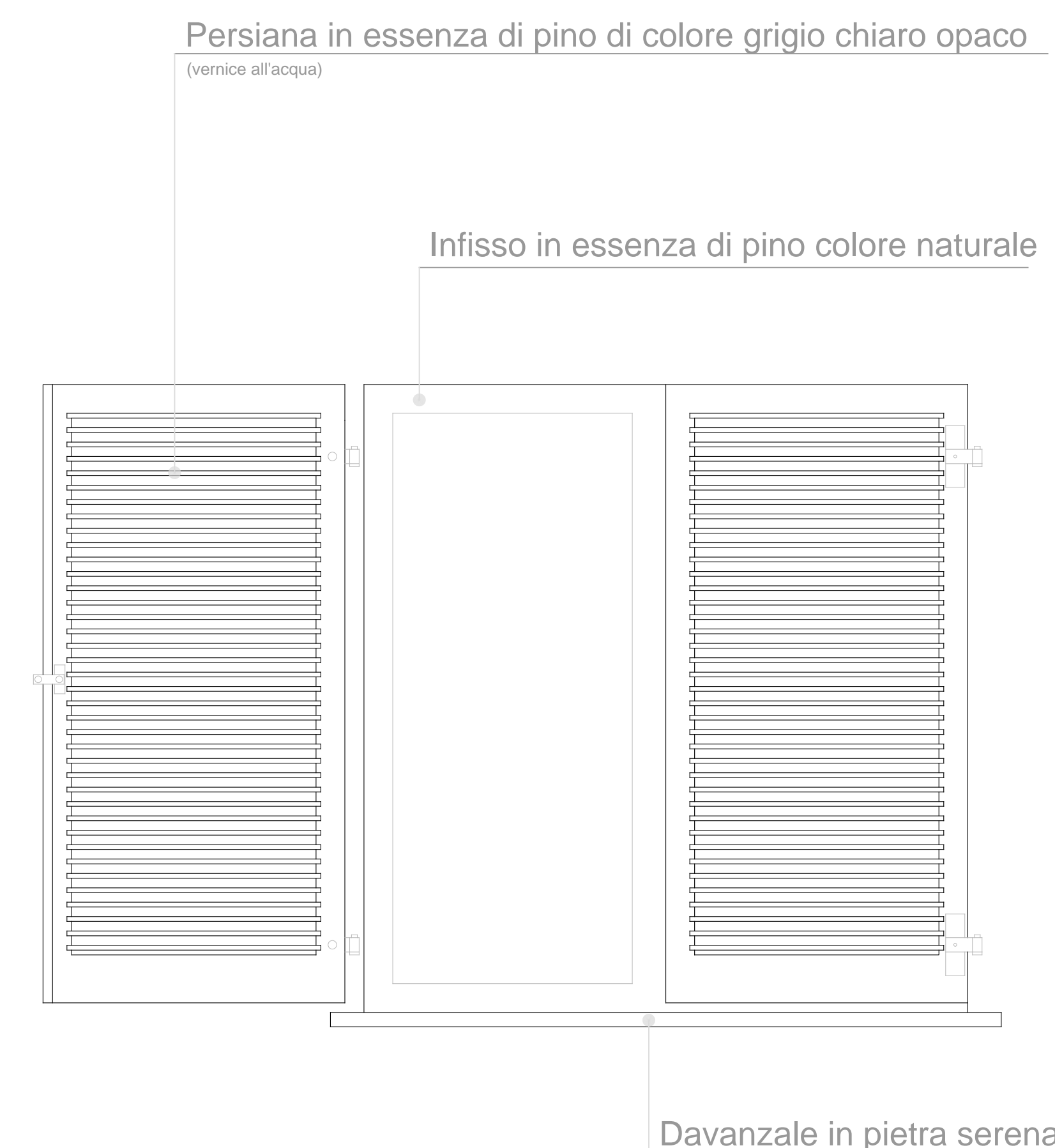
Prospetto finestra tipo
